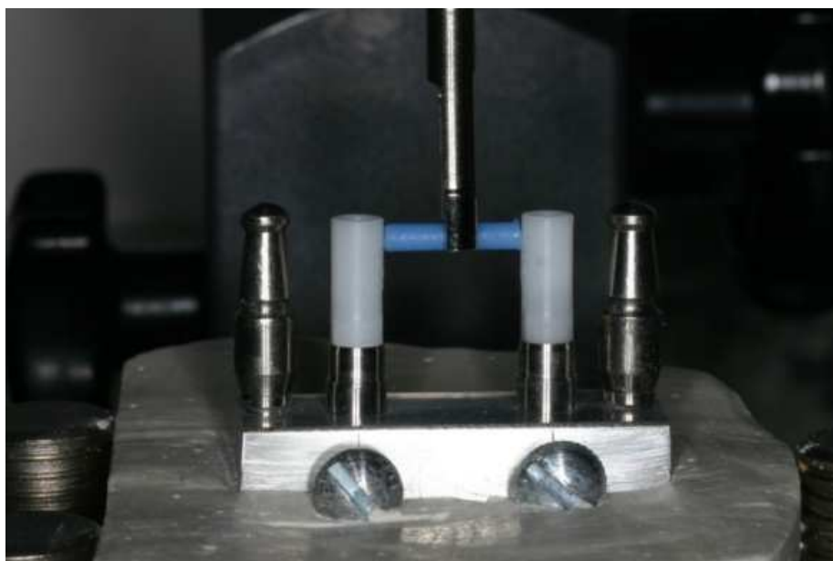
Figura 4. Montagem das barras dos padrões de fundição.
